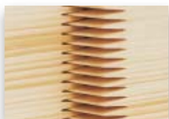
Detail: nekonečný spoj u KVH hranolov.
