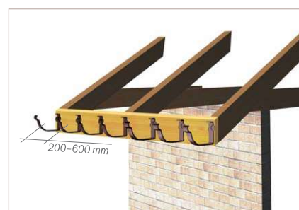
Obr. 4 – umístění háků kombi
