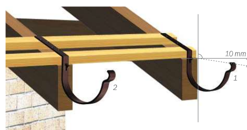
Obr. 7 – umístění háků do krokví, ohyb od objektu
