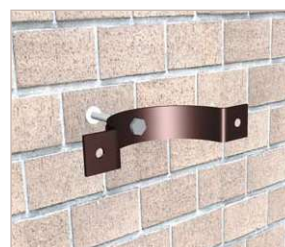
Obr. 19 – montáž objímek svodu
